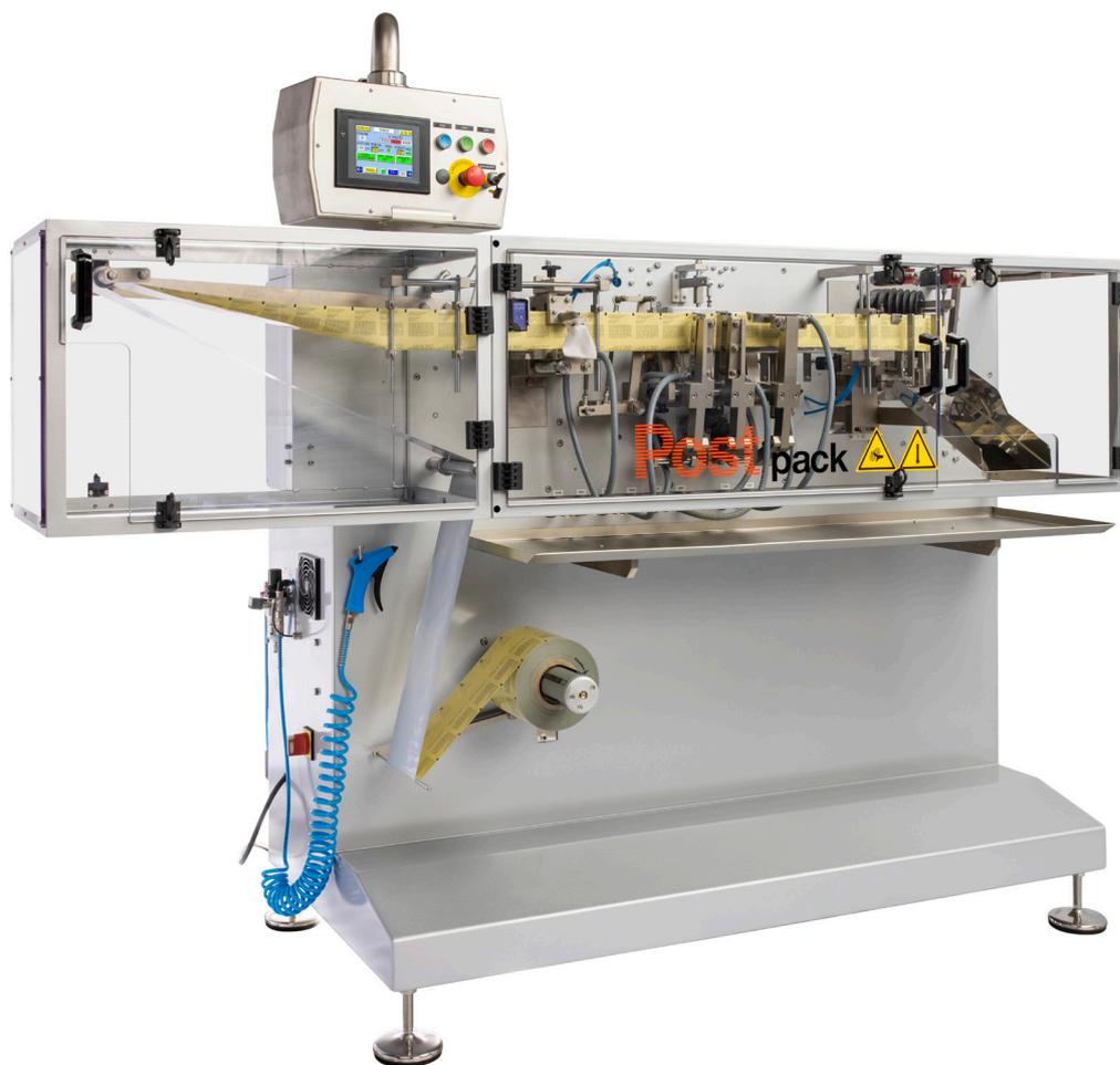
Las máquinas automáticas POSTPACK, de la serie MH-110, tanto en su versión simple como duplex, han estado desarrolladas para el envasado de productos en polvo, granulados, líquidos o pastosos así como para el envasado de toallitas refrescantes en sobres de tres o cuatro soldaduras.
