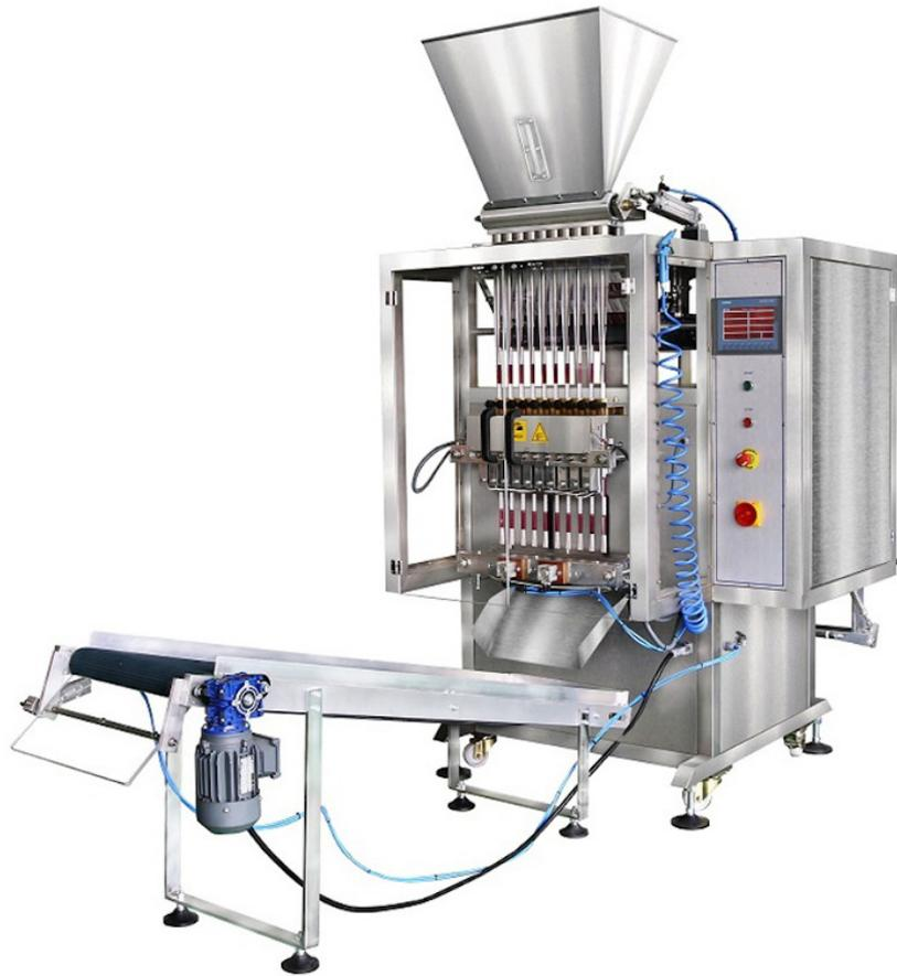
**Las máquinas stickpack verticales, son máquinas totalmente automáticas, de alta velocidad, especialmente diseñadas para el llenado de stickpacks con sellado por 3 caras y que pueden trabajar con diferentes tipos de productos (polvo, granulado, líquido, etc...).**
